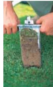
За вземане на пробы от носещия слой за анализ. Оборудвана с практичен механизъм за отваряне за щадяща обработка на пробите.
