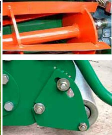
Произведена с 34" (86 сантиметра), широчина на рязане, тази косачка се захранва от 8 к.с. въздушно охлажддане едноцилиндров четиритактов бензинов двигател (Honda). Задния барабан и нож се контролират независимо, чрез конзолата на кормилото. Ръчна спирачка е поставена за допълнителна безопасност при работа върху наклонен терен.
