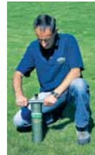
За вземане на проба от носещия слой с неувредено ядро на пробата. За измерване на дебелината на слоевете, за определя на водопропускливостта и за оценка на кореняването. Оборудван с практичен механизъм за щадяща обработка на пробите.
