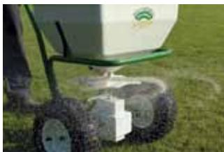
Покрива голяма площ и пести време (до 1.000 кв.м за 5 минути) и разпределя равномерно разпръсквания материал – поради това Rotary IV е превъзходна оферта в областта на уредите за разпръскване на тор.
