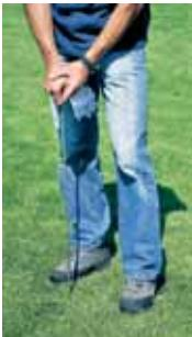
За изследване на хоризонтите на уплътняване в конструкцията на почвата и на носещия слой. Дава възможност за своевременно откриване на промени в почвата.
