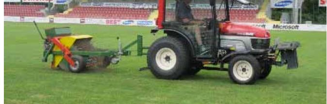
Модерна професионална високоефективна машина с двойна функция: за сейтба с перфориране и за аериране, а когато се включи и посипване с пясък, се превръща в машина за отслабване на тревната покривка. Уникална конструкция на **EUROGREEN** с вертикално набождащи и бождащи зъбци /лапи/ за щадяща обработка.
